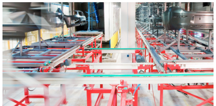
Skid Förderer mit platzsparender Querfahrt zum Richtungswechsel.
