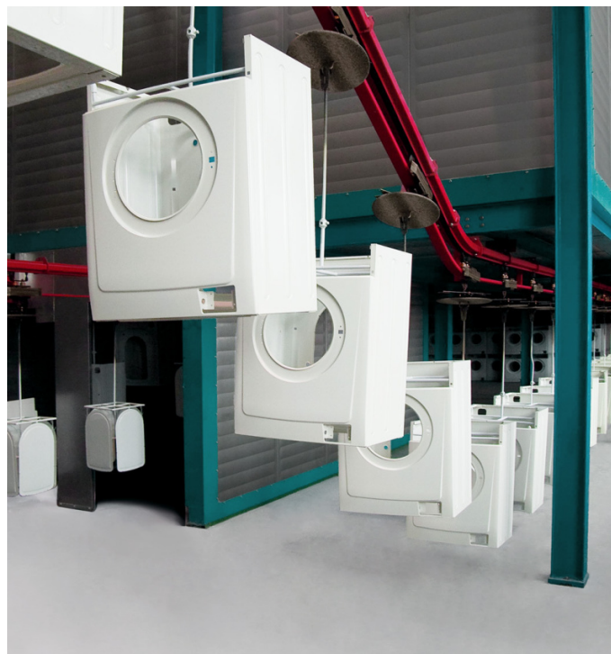
Steigfähiger Kreisförderer mit Trockner und A-Schleuse.
