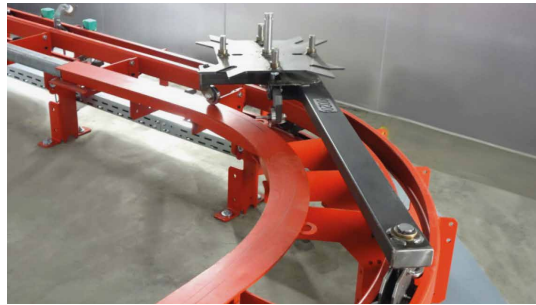
Trasportatore E-Conveyor iP&F con braccio personalizzato
