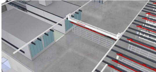
Lackieranlage für Trailer – Transferbrücke mit Wagenzug.
