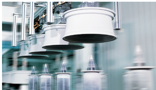
Umsetzung auf drehbare Spindeln im Lackierbereich.
