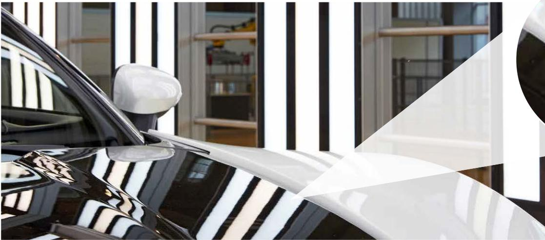
Mit VariolInspect wird der Kontrast durch die Anpassung der Lichtfarbe optimiert. Dadurch wird die Erkennbarkeit des Reflexbildes auf weißen Oberflächen verbessert.
